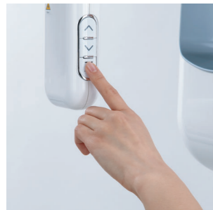
El control de activación remoto incluye interruptor de parada de emergencia.
